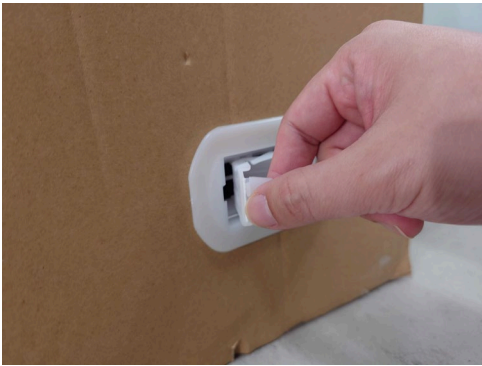
ディスプレイ下部にある ジョイントパーツを全て外す
